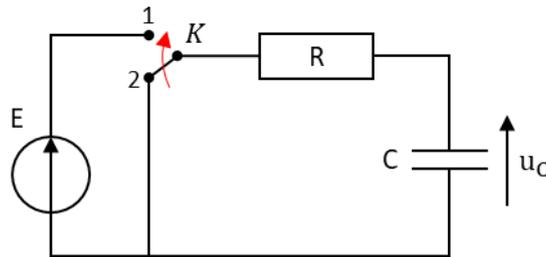
À l'instant  $t = 0$ , on place l'interrupteur  $K$  dans la position (1), le condensateur étant déchargé.
