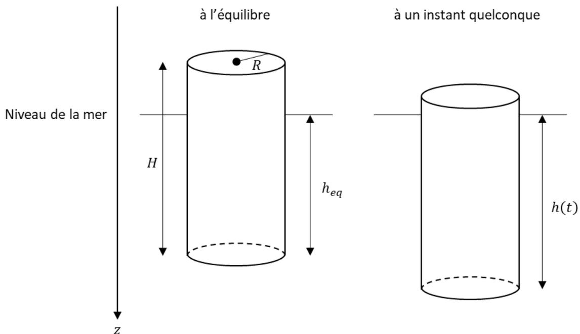
On décrit le mouvement du centre de masse  $G$  selon l'axe vertical ( $Oz$ ) dirigé vers le bas. L'origine  $O$  correspond à la surface de l'eau. On note  $h_{eq}$  la hauteur immergée lorsque le flotteur est à l'équilibre. On note  $h(t)$  la hauteur immergée à un instant  $t$  quelconque.
