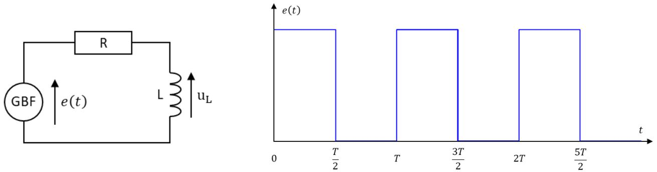
9) On définit la constante de temps  $\tau$ , exprimée en secondes, du circuit (RL) par une relation du type  $\tau = L^\alpha R^\beta$  où  $\alpha$  et  $\beta$  sont deux constantes réelles. En résonant sur les relations entre  $i$  et  $u$  des dipôles, déterminer la valeur des exposants  $\alpha$  et  $\beta$ .
