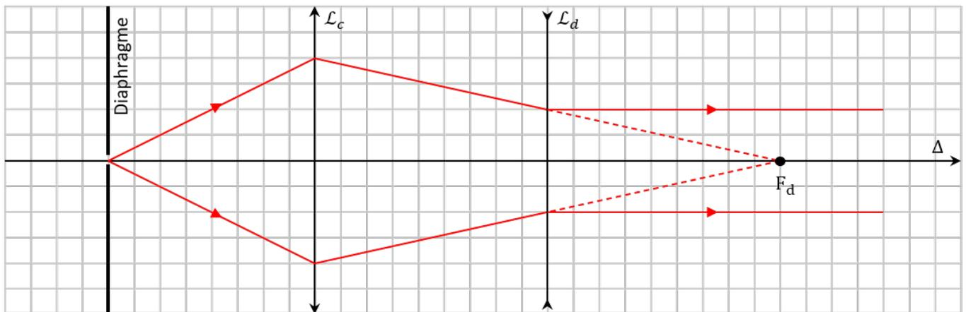
⚙️ Réaliser le montage sans la lentille divergente. Repérer la position de l'image du diaphragme.
